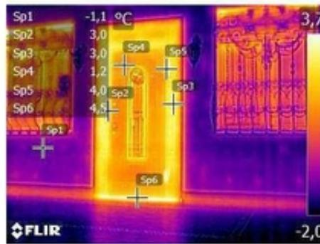
Из-за недостаточного утепления и отсутствия уплотнителя внизу происходят значительные теплопотери через входную дверь
